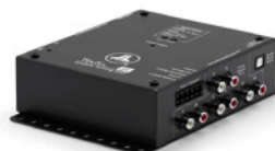
JL AUDIO TwK-88 - DSP de ajuste de sistema, 8 entradas analógicas/digitales, 8 salidas Ref: 010-03166-00 Ver más >
